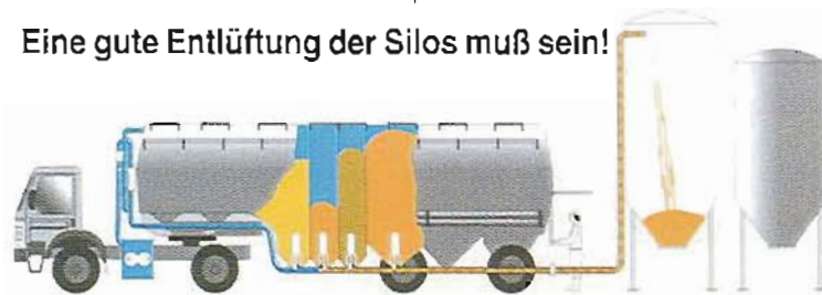
Entladen der Tankzüge mit Luft
